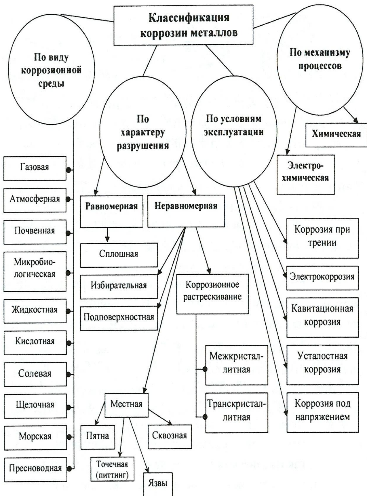
Рисунок 3.1. Общая классификация коррозионных процессов
